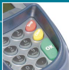
Tastatur mit ergonomischem Sichtschutz und taktilen Symbolen
